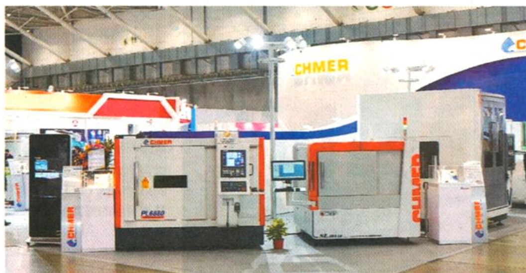
●慶鴻機電創新研發高精密飛秒雷射切割機與高精密光纖雷射切割機，滿足半導體、電子等產業之高精密切割需求。圖/業者提供
